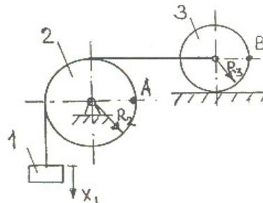
3. Визначити швидкість тіла 1 коли його шлях  $S_1 = 2 \text{ м}$ , якщо механічна система з 3 тіл починає рухатися із стану спокою під впливом сили ваги тіла 1.
